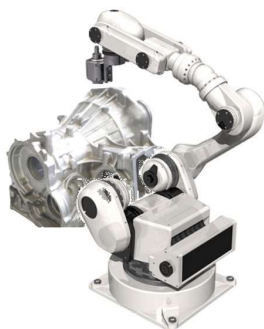
図 8. ロボットによるエンジン部品の画像撮影
